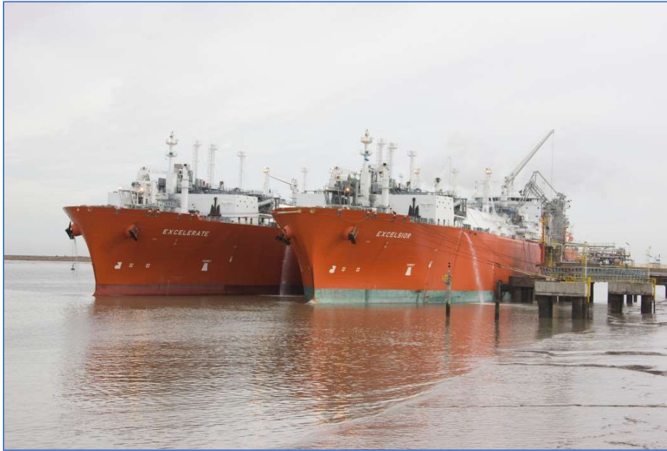
Figura 11: Navio Regaseificador (F.S.R.U) e navio supridor atracados no terminal de GNL de Baía Blanca (Argentina).
